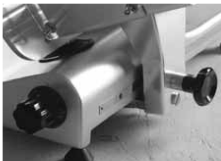
Ρυθμιστής διαδρομής πλατφόρμας, με μηχανισμό κλειδώματος
